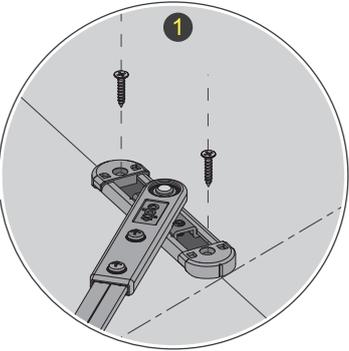
Вариант внутреннего крепления направляющего механизма (под крышу)
