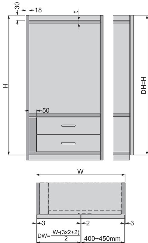
Вариант внутреннего крепления направляющего механизма (под крышей)
